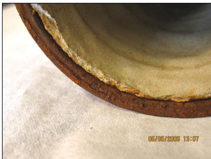
Fig 5.5 Prøve II. Reliningmateriale løsnet og vasket bort
